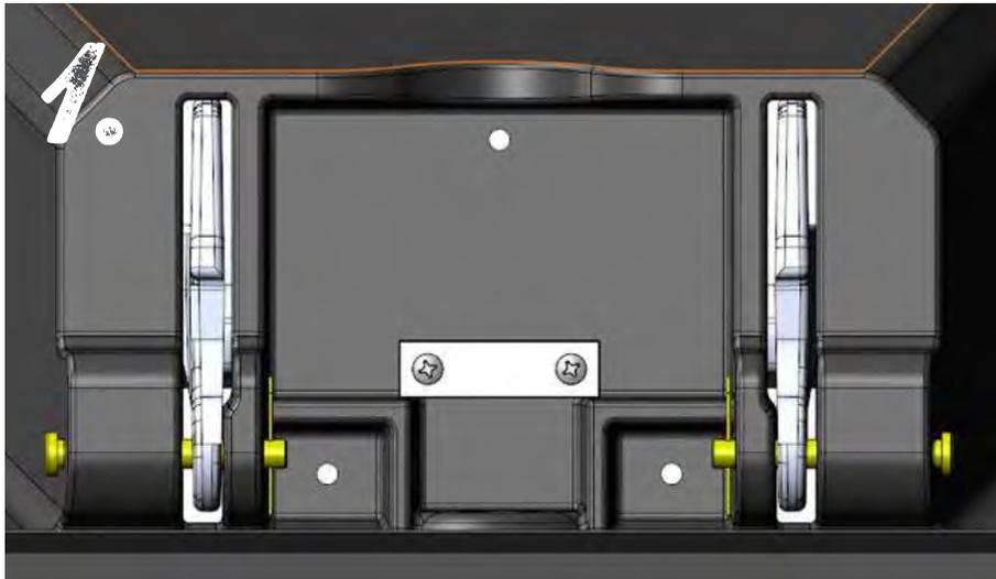
**STEP 1:** ATTACH LOCK BRACE TO DRAWER WITH SCREWS PROVIDED. ALIGN BRACE AGAINST LOCK CAVITY WALLS AS SHOWN. **DO NOT** OVERTIGHTEN SCREWS!
